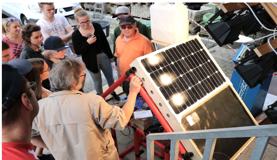
Le capteur thermique et le panneau PV éclairés au soleil artificiel
