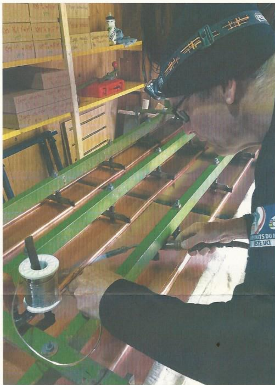
La plus grande concentration et le doigté sont nécessaires au brasage de l'absorbeur.
