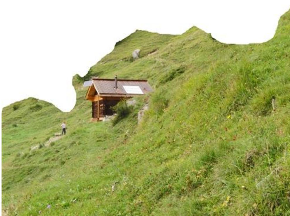
4.5m<sup>2</sup> de solaire, presque hors-gel à 2000m, avec 0.5m<sup>2</sup> de panneau PV et 5 W de consommation circulateur & régul
